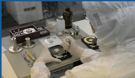
HDDを開封し、磁気ヘッドの交換など処置を施します
