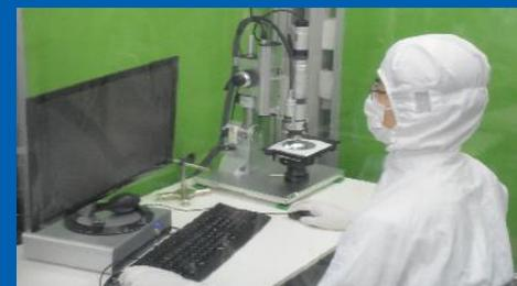
高倍率の検査装置を用いて、故障箇所を特定し修理を行います
